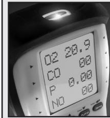
À la fin de la réinitialisation de l'analyseur, tournez le sélecteur de test sur l'écran de test approprié. Appuyez sur « ▲ » HAUT (UP) à tout moment pour activer le rétroéclairage et la lampe. REMARQUE : le rétroéclairage ne fonctionne pas dans le menu carburant ou durant la purge.
