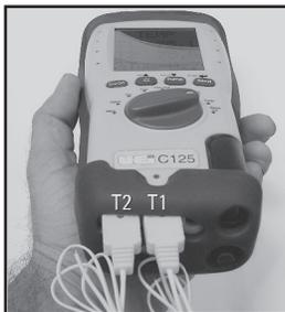
Branchez le connecteur du thermocouple de la sonde de fumée ou du thermocouple secondaire à T1. Connectez le thermocouple secondaire à T2. Compatible avec toutes les pinces ou sondes de thermocouple de type K.
