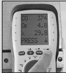
Avant l'activation du ventilateur, et après que les mesures se soient stabilisées, appuyez sur le bouton ENVOYER (SEND). Cela permettra d'enregistrer le segment de test avant ventilateur.
