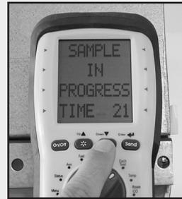
L'appareil de mesure attendra 30 secondes, puis enregistrera les valeurs après ventilateur pour le CO, O<sub>2</sub> et l'excès d'air. Les résultats des tests seront automatiquement enregistrés dans les rapports d'échange. Le rapport comprend deux segments de test avant et après ventilateur.
