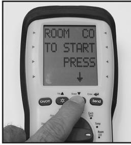
Pas de sondes ou raccords de tuyaux requis pour ce test. Placez le combiné dans la zone à tester. Tournez le sélecteur de test sur Chambre de CO.
