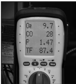
Tournez le sélecteur sur « Test fumées » (Flue Test) et commencez le test.
