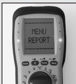
Pour afficher les résultats enregistrés, tournez le sélecteur de test sur « MENU », allez à l'écran « RAPPORT » (REPORT) et sélectionnez le test désiré. Sélectionnez « AFFICHER » (VIEW) et faites défiler jusqu'aux résultats souhaités. Appuyez sur « ENVOYER » (SEND) pour imprimer.
