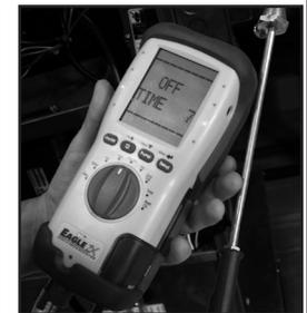
Une fois terminé, retirez la sonde du conduit et laissez l'analyseur purger l'air frais jusqu'à ce que les mesures du capteur de CO se remettent à zéro et que O2 indique 20~21 % (20,9 %). Passez au test suivant ou éteignez votre analyseur lorsque vous avez terminé.
