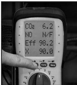
Appuyez et maintenez le bouton « ▲ » HAUT (UP) pour basculer entre les écrans de test de carburant 1 et 2.
