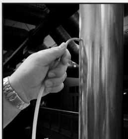
Placez le tuyau de tirage et la pointe de la sonde dans le conduit pour mesurer le tirage. Vous pouvez également utiliser la sonde de tirage de combustion pour mesurer la pression.
