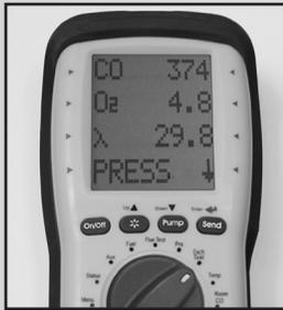
Tournez le sélecteur de test sur Test éch (Exch Test). Appel de chaleur dans le système. Observez et attendez que les mesures d'O<sub>2</sub> se stabilisent.
