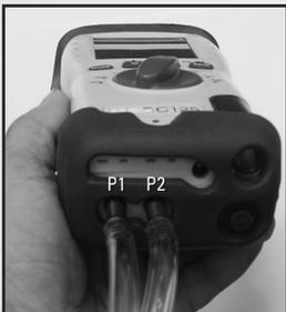
Raccordez le tuyau de tirage et la sonde dans P1. Utilisez P2 pour Différentiel. Placez la pointe de la sonde dans le conduit pour mesurer le tirage. Raccordez le tuyau de pression statique à P1 et P2 pour mesurer la pression différentielle.
