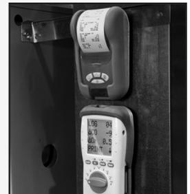
Pour afficher les résultats des tests, tournez le sélecteur de test sur « MENU », allez à l'écran « RAPPORT » (REPORT) et sélectionnez ÉCH (EXCH). Sélectionnez « AFFICHER » (VIEW) et faites défiler jusqu'au journal souhaité. Appuyez sur « ENVOYER » (SEND) pour imprimer.
