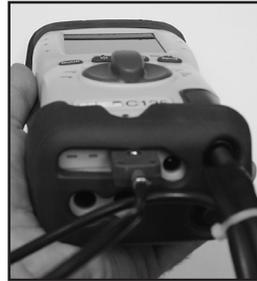
Branchez le connecteur du thermocouple de la sonde de fumée à T1, puis raccordez la sonde de fumée au siphon comme indiqué ci-dessus. Utilisez une sonde en option avec T2 pour la température d'entrée.
