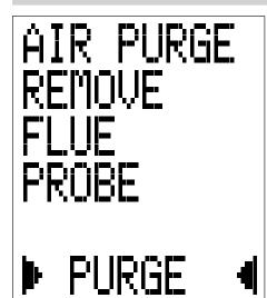
Chaque fois que l'analyseur est allumé, il effectue une purge d'air de 60 secondes, afin de dégager le chemin d'échantillonnage du gaz (y compris la sonde, si elle est connectée) et d'auto-étalonner le système de détection du CO2. Pour ces raisons, il est très important que l'analyseur soit à **l'air frais extérieur** lorsqu'il est allumé.
