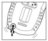
Retirer la gaine en caoutchouc et le bouchon de vidange rouge. Laisser l'eau s'écouler. Réinsérer le bouchon en caoutchouc et remettre le couvercle de la gaine.
