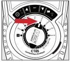
Tourner le cadran à **COM TEST**
