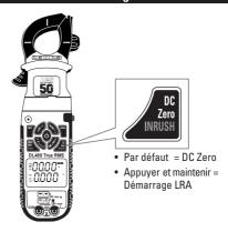
Le Démarrage LRA UEi est programmé pour capter correctement le courant de démarrage des moteurs de compresseurs.
