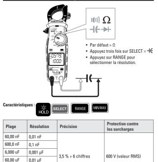
AVERTISSEMENT Pour éviter d'endommager le multimètre ou l'équipement testé, déchargez de façon sécuritaire les condensateurs avant de mesurer la capacité. Les condensateurs à grande capacité doivent être déchargés par une charge de résistance appropriée. Utilisez la fonction de tension CC pour confirmer le déchargement des condensateurs.
