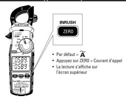
Le courant d'appel à rotor bloqué de UEi est programmé pour bien capturer le courant de démarrage des moteurs de compresseur.
